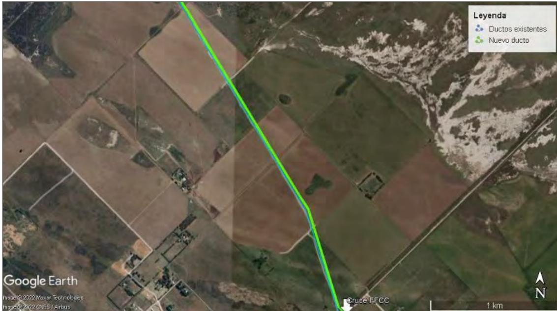
En este punto la traza del nuevo ducto realiza un cambio de dirección para atravesar un camino de tierra y unas vías férreas para retomar luego la picada existente y continuar en la misma posición respecto de los ductos existentes.
