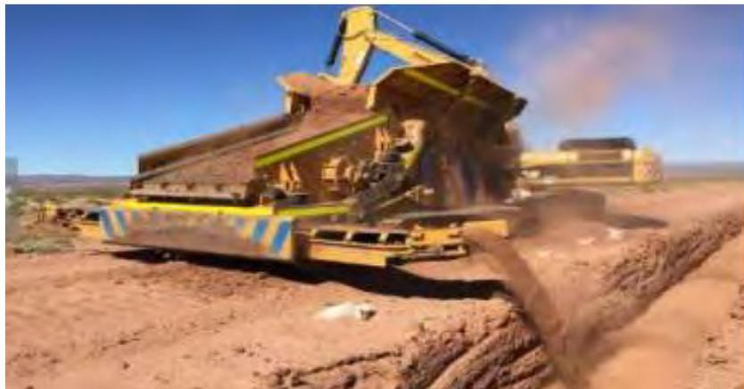
Foto 8. Criba vibratoria autopropulsada
