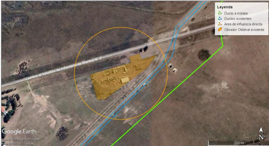
La locación de acometida para la colocación de la planta de perforación en el cruce del arroyo pareja requiere aproximadamente 2000 m<sup>2</sup> de superficie (50 m x 40 m). Considerando un área circular de 40 m de radio, se tiene un AID adicional de 5200 m<sup>2</sup> de AID en el entorno de la locación.
